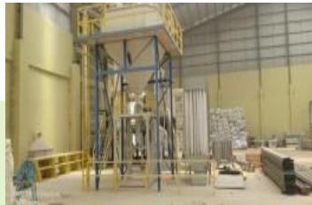
Pabrik Subang, Pemrosesan sekam menjadi pelet
